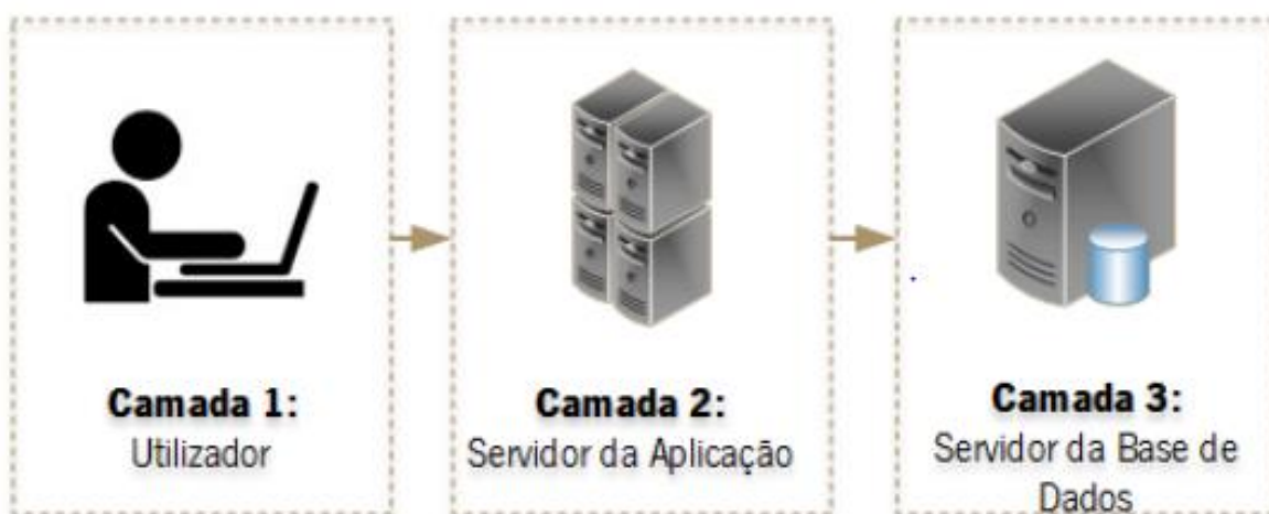
Figura 6-Exemplo de arquitetura de três camadas
